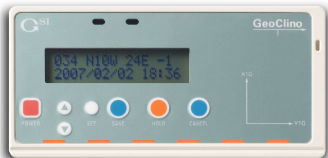
第 1 図 デジタルクリノメーター GeoClino
